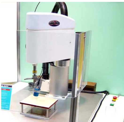
Sistema di Saldatura con sorgente Laser applicato su un Robot SCARA
