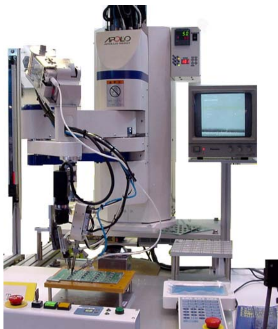
Robot a 4 assi tipo Scara con prelievo parti - posizionamento e relativo assemblaggio (saldatura o altro)
