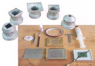
Ugelli di precisione, relazzati in due parti: Parte comune di innesto rapido e parte finale con scappamento aria.
