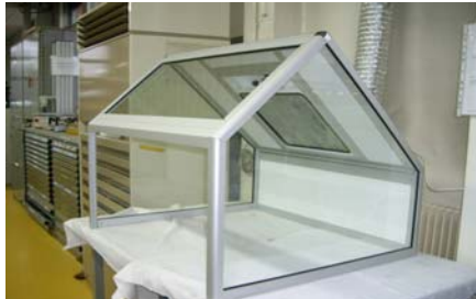
Cabina con forma superiore a tetto per diminuire l'altezza totale
