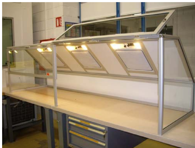
Cabina di grandi dimensioni con tre gruppi Filtranti/Motore
